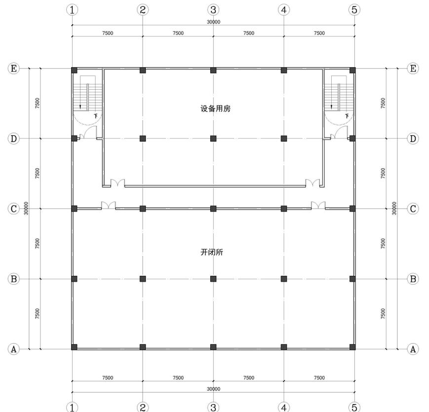
综合站房 (开闭所、水泵房、制氮站) 平面图
